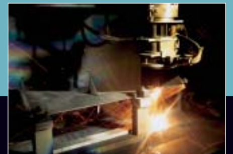
Fan blade repair
